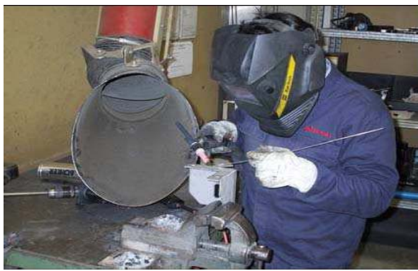
Figura 18 – Postazione di saldatura (con uso di materiale d'apporto) con bocca di aspirazione
