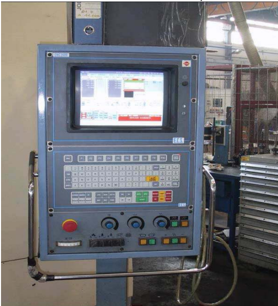
Figura 30 – Quadro di programmazione centro di lavoro
