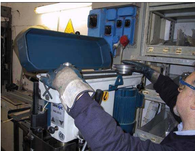
Figura 7 – Cambio della velocità di rotazione del mandrino
