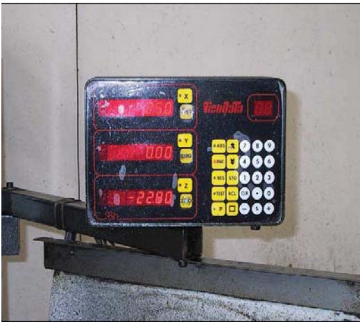
Figura 15 – Quadro di comando della fresatrice (notare i comandi per il moto del pezzo nelle tre direzioni X, Y e Z)
