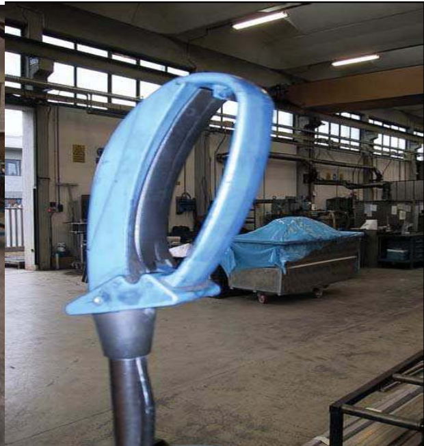
Figura 10 – Interruttore a pressione continua posto sull'impugnatura
