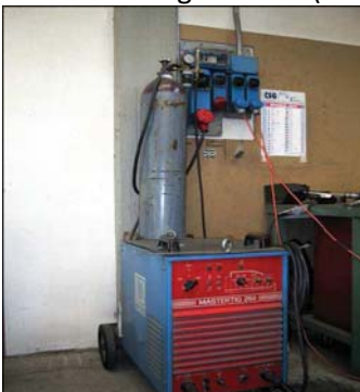
Figura 16 – Generatore e bombola di gas inerte
