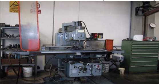
Figura 13 – Macchina con riparo mobile aperto
