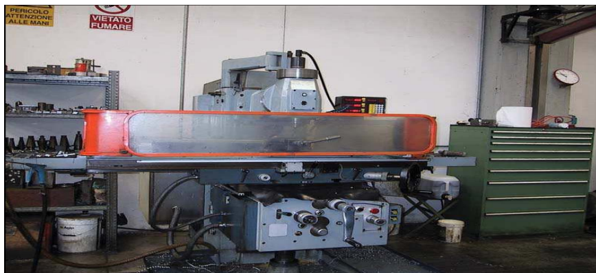
Figura 12 – Fresatrice dotata di riparo mobile con dispositivo di blocco
